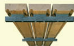
deska iroko , gładka 10,8 x 2,0 cm / polietylenowe podkładki 1,3 cm + polietylenowe legary montażowe deck-u 3,0 cm / deck poziomy / podłoże – kontr. stalowa na słupkach betonowych
