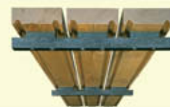
deska garapa 14,0 x 2,1 cm, gładka / polietylenowe podkładki 1,3 cm + polietylenowe legary montażowe deck-u 3,0 cm / deck poziomy / podłoże - styrodur + geowłóknina
